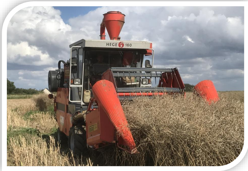
Récolte des essais colza de Tilly (27) avec une moissonneuse batteuse d'expérimentation
